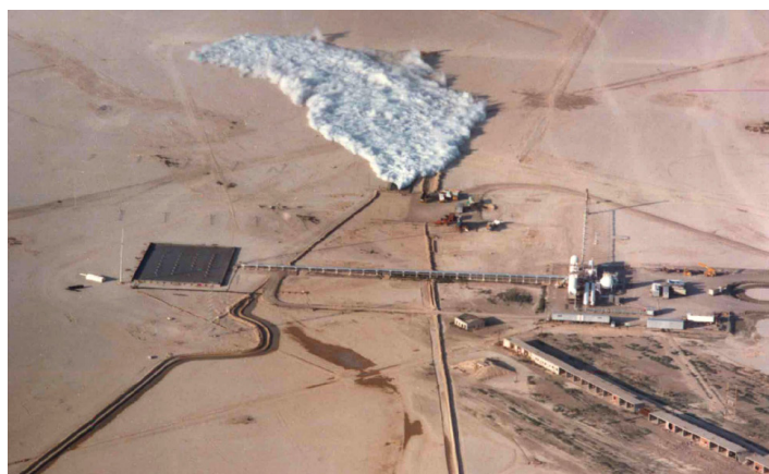
Gráfica 2: Una prueba de liberación de HF realizada en 1986 en un centro de pruebas en el desierto de Nevada, que muestra la formación de una densa nube que se adhiere al suelo.
