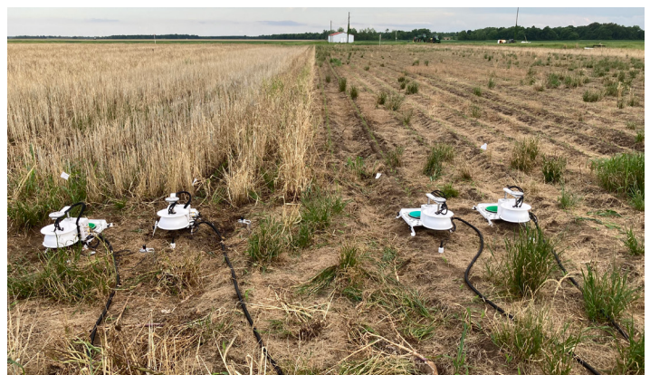
Los instrumentos como las cámaras de flujo son vitales para el seguimiento de las emisiones de óxido nitroso.
